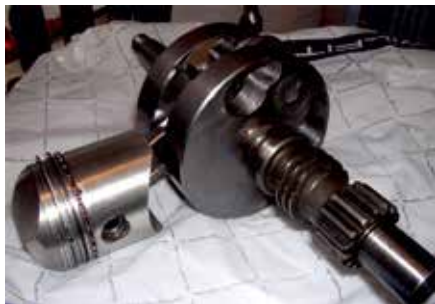
Det färdiga vevpartiet. Balanserat, ny kolv, modifierat vevlager.
