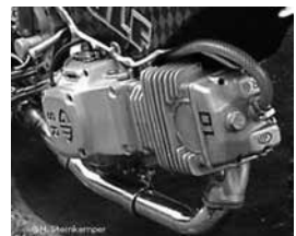
Kännetecknande för GM-motor med stående cylinder
